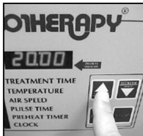
Presionar los botones de "AUMENTAR" y "DISMINUIR" para poner en el aparato el tiempo de tratamiento por defecto deseado.
