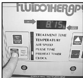
Appuyez sur le bouton « PRESS ONCE TO TURN ON PREHEAT TIMER » (APPUYER UNE FOIS POUR ACTIVER LA MINUTERIE DU PRÉCHAUFFAGE) pour allumer l'indicateur d'activation « PREHEAT TIMER » (MINUTERIE DU PRÉCHAUFFAGE). Appuyez une nouvelle fois pour démarrer la MINUTERIE DU PRÉCHAUFFAGE.
