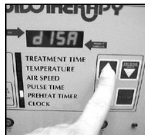
Presionar el botón "AUMENTAR" para fijar en el aparato la visualización de "EnAb" o "dISA" deseada.
