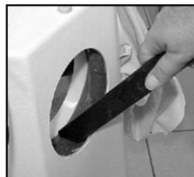
Limpiar con aspiradora el medio Cellex que pueda haber entrado en la cavidad entre las paredes interna y externa del aparato.
