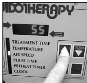
Presionar los botones de "AUMENTAR" o "DISMINUIR" hasta que se visualice la Velocidad del Aire deseada.
