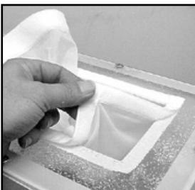
Détachez délicatement les fermetures auto-agrippantes l'une de l'autre pour détacher le manchon de l'appareil.
