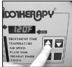
Appuyez sur les boutons « INCREASE » (AUGMENTER) et « DECREASE » (DIMINUER) pour régler la température de traitement par défaut de l'appareil.
