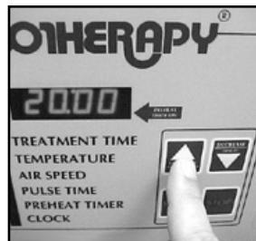
Appuyez sur les boutons « INCREASE » (AUGMENTER) et « DECREASE » (DIMINUER) pour régler la durée du traitement par défaut sur l'appareil.
