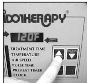
Presionar los botones de "AUMENTAR" y "DISMINUIR" para fijar en el aparato la temperatura de tratamiento por defecto deseada.
