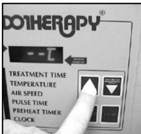
Presionar el botón "AUMENTAR" para establecer que se visualice en el aparato °F o °C según se desee para la posición por defecto.
